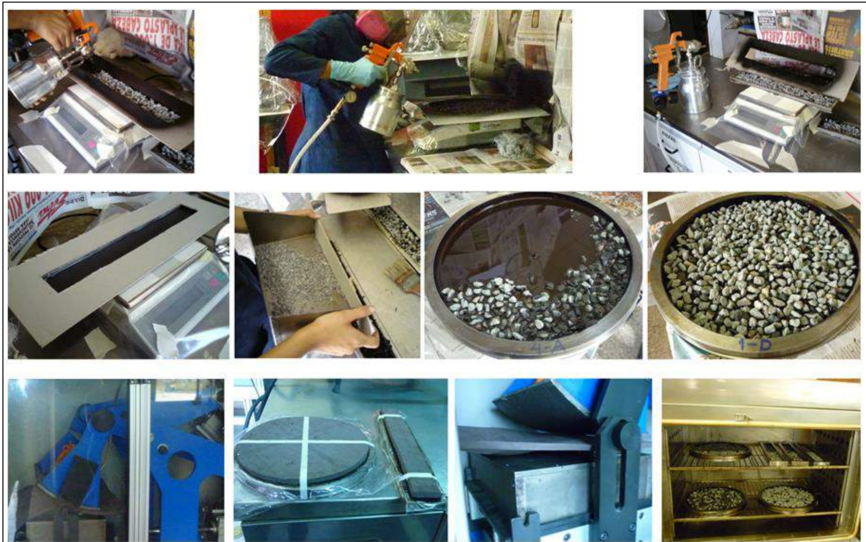
Figura 4-5. Proceso de fabricación de las muestras
