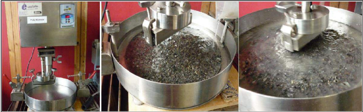
Figura 2-23. Ensayo de la Pista Húmeda
