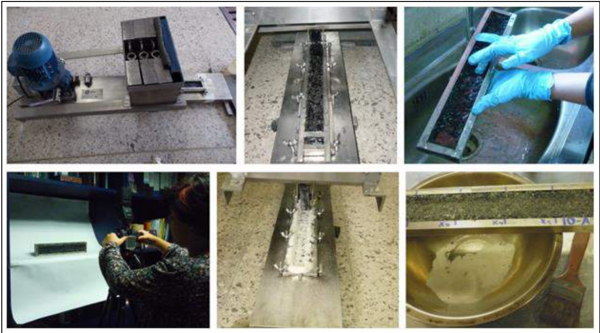
Figura 4-9. Procedimiento del ensayo de exceso de asfalto
