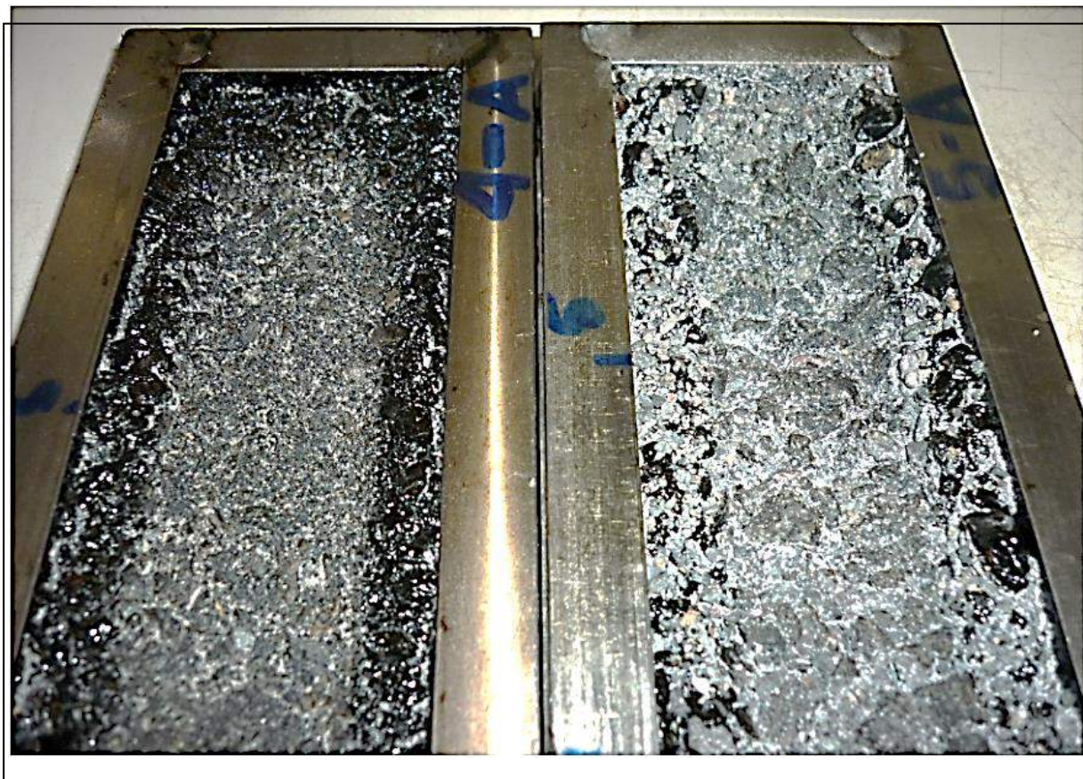
Figura 5-6.Comparación entre muestras del ensayo de exceso de asfalto, designación 3A
