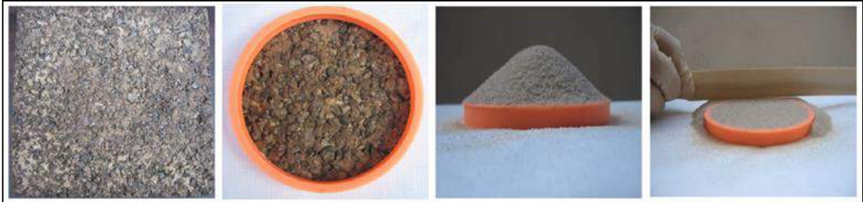
Figura 2-21. Procedimiento del Ensayo del Círculo de Arena Modificado
