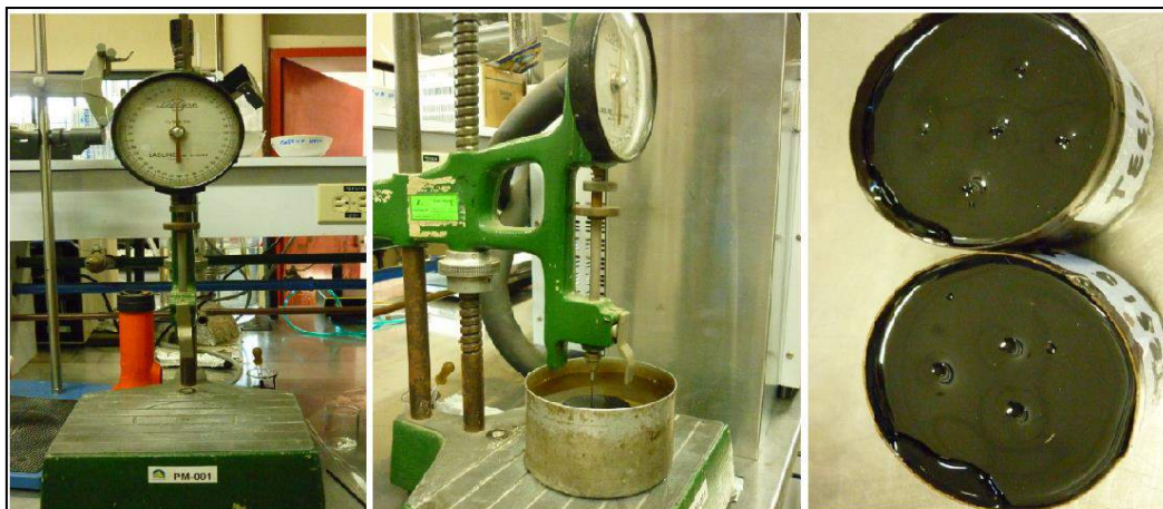
Figura 2-13. Equipo para el ensayo de penetración y muestras ensayadas
