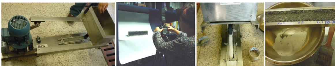
**Figura 4: Procedimiento del ensayo de medición del exceso de asfalto**
