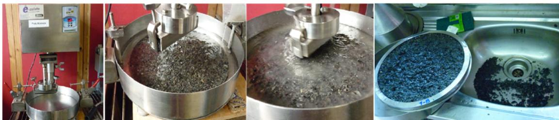
**Figura 3: Procedimiento del ensayo de medición de la pérdida de agregado**
